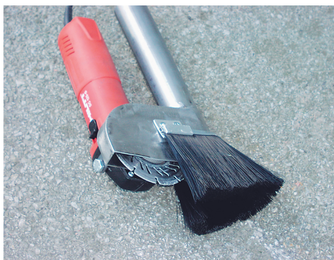
Vinkelslip från Hilti för sågning i betong invid fogmassa.
