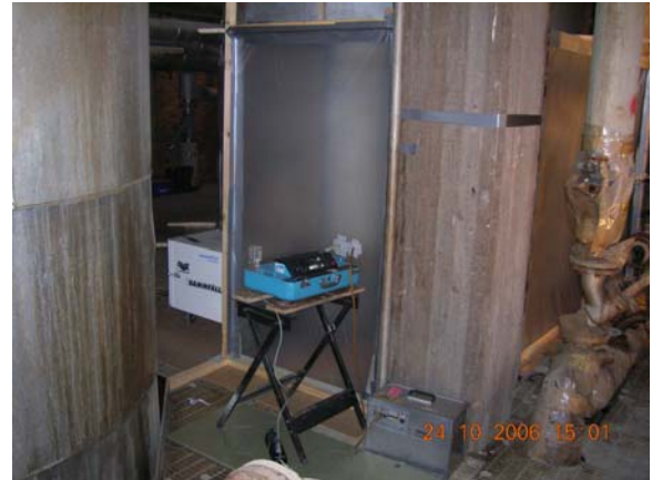
Bild 13. På bilden ses det direktvisande instrumentet och fläkten som håller undertryck i zonen.
