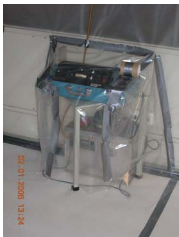
Bild 40. FAM inkapslad, mäter halter i zonen
