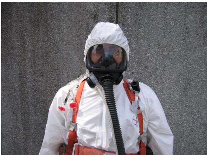
Bild 8: Andningsskydd från Sundström Safety AB användes. Mätningar utfördes innanför andningsskyddet samt i axelnivå utanför andningsskyddet.
