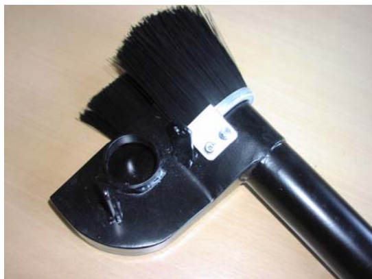
Bild 9: Vidareutvecklad kåpa för dammuppsamling, för Hilti vinkelslip med 125 mm kapskiva.
