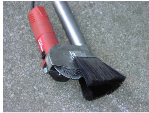
Bild 6: Vinkelslip från Hilti (DC 125-S/EX) med kapskiva för sågning i betong, försedd med ny utsugskåpa från SP.
